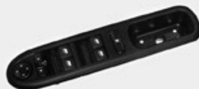
V1378 OEM: 6554.ER Peugeot 307 - 308 - 408 / tecla alza vidrios cuádruple con control espejo eléctrico y traba vidrios traseros / iluminada
